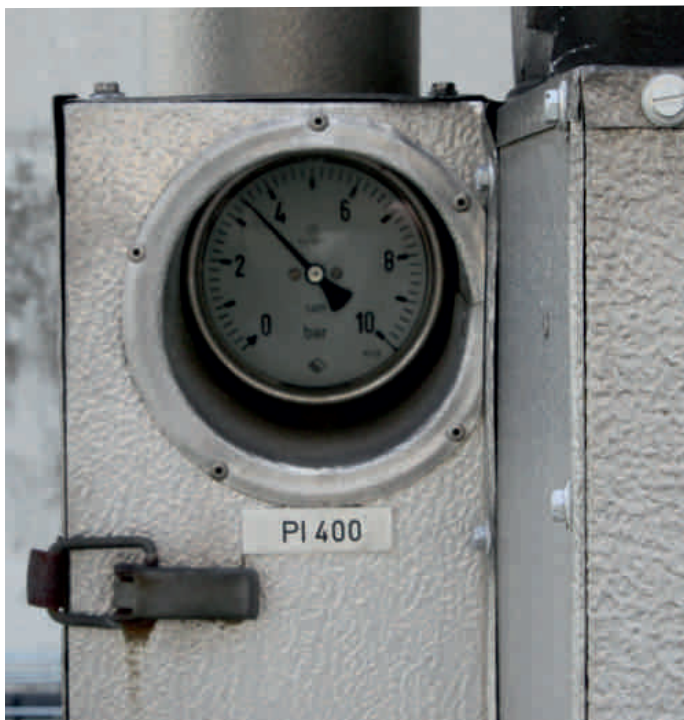
Die automatische Regelung garantiert einen konstanten Druck unabhängig vom aktuellen Kühlmittelbedarf.
