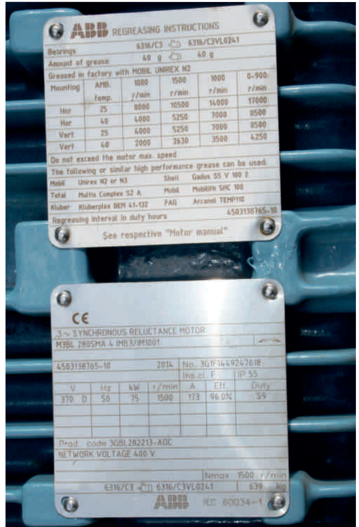
Die neu installierten Motoren würden sich allein durch ihren höheren Wirkungsgrad auch ohne FU innerhalb von drei Jahren amortisieren.
