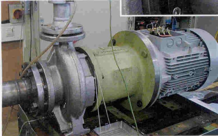
In umfangreichen Versuchen hat Allweiler die Eignung von Magnetkupplungspumpen für Einsätze in explosionsgefährdeten Bereichen getestet und nachgewiesen. Dazu wurde u.a. an der Außenwand des Spalttopfs ein Thermoelement fixiert.
