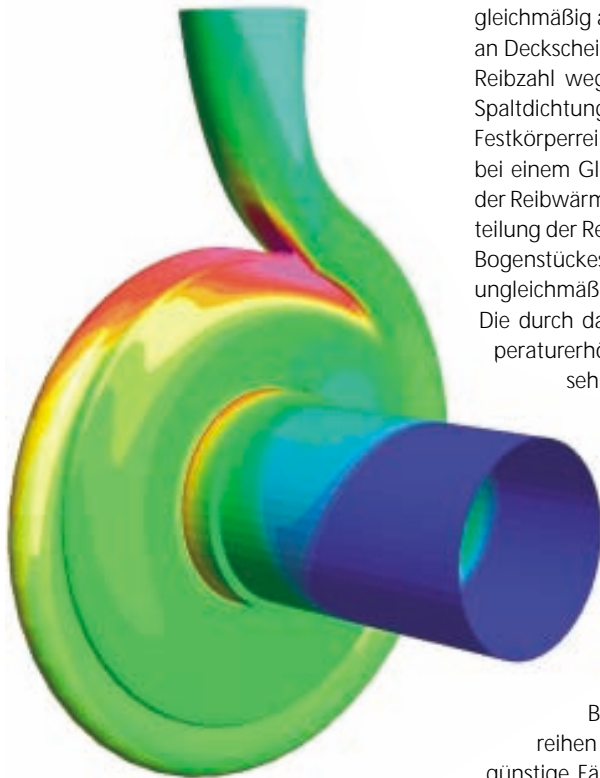
2: Verteilung des Wärmeübergangskoeffizienten in W/m^2K an den Innenflächen von 5 \cdot 10^2 (blau) bis 1 \cdot 10^5 W/m^2K (rot)
