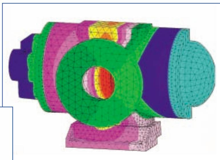
1b: Temperaturverteilung im Schadensfall von 45 °C (hellblau) bis 125 °C (dunkelrot)
