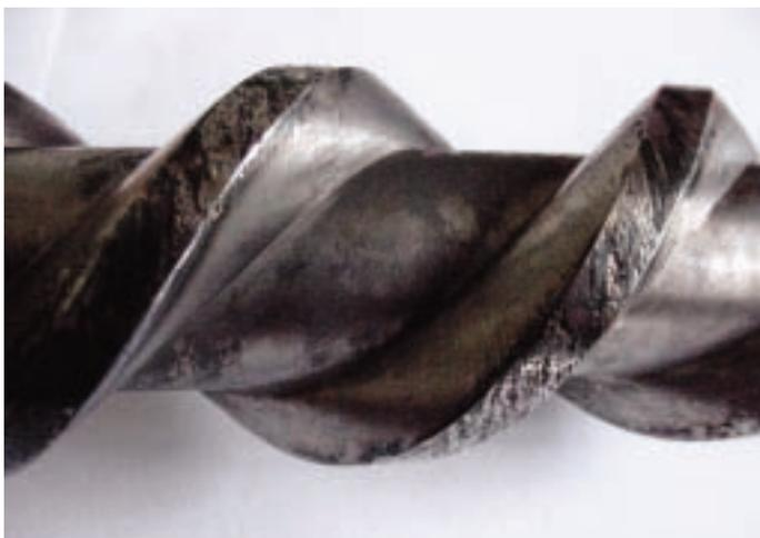
**3: Adhäsionsverschleiß an den Laufflächen einer Schraubenspindel**
